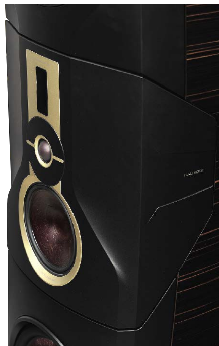
Głośniki sekcji średnio-wysokotonowej są mocowane do masywnego, odlewanego, aluminiowego panelu, który zapewnia ich izolację od wibracji głównej skrzyni.
